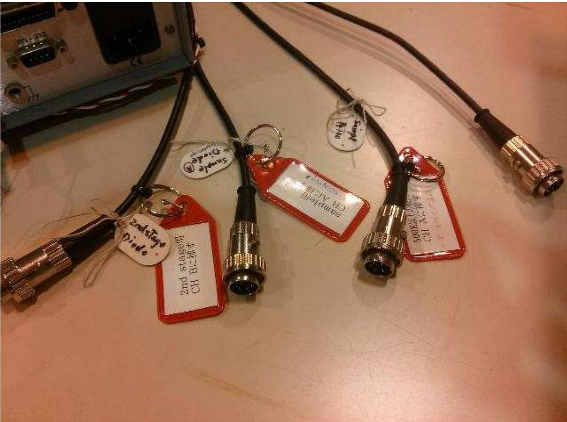
コントローラー背面に接続する温度センサーケーブルは、3種類です。
